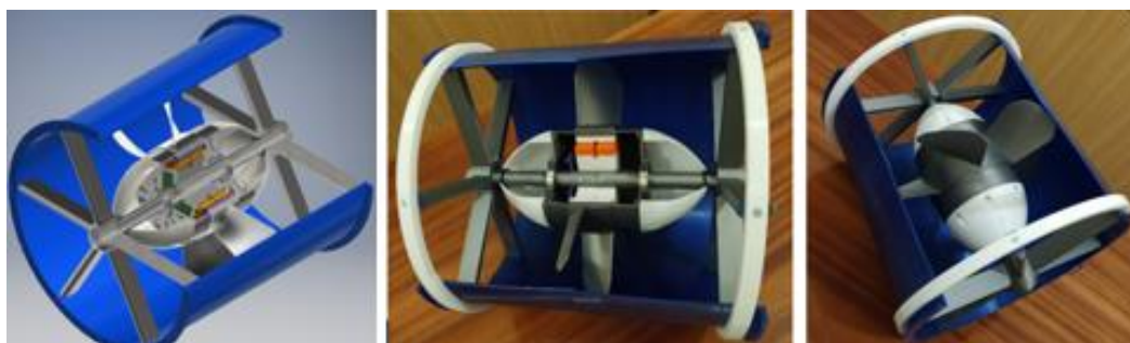
Расми 2. Аксҳои модели-амсилаи миқёсии генератори ангиизи омехта барои НБОХ, ки бо технологияи 3D тайёр гардидаанд.
